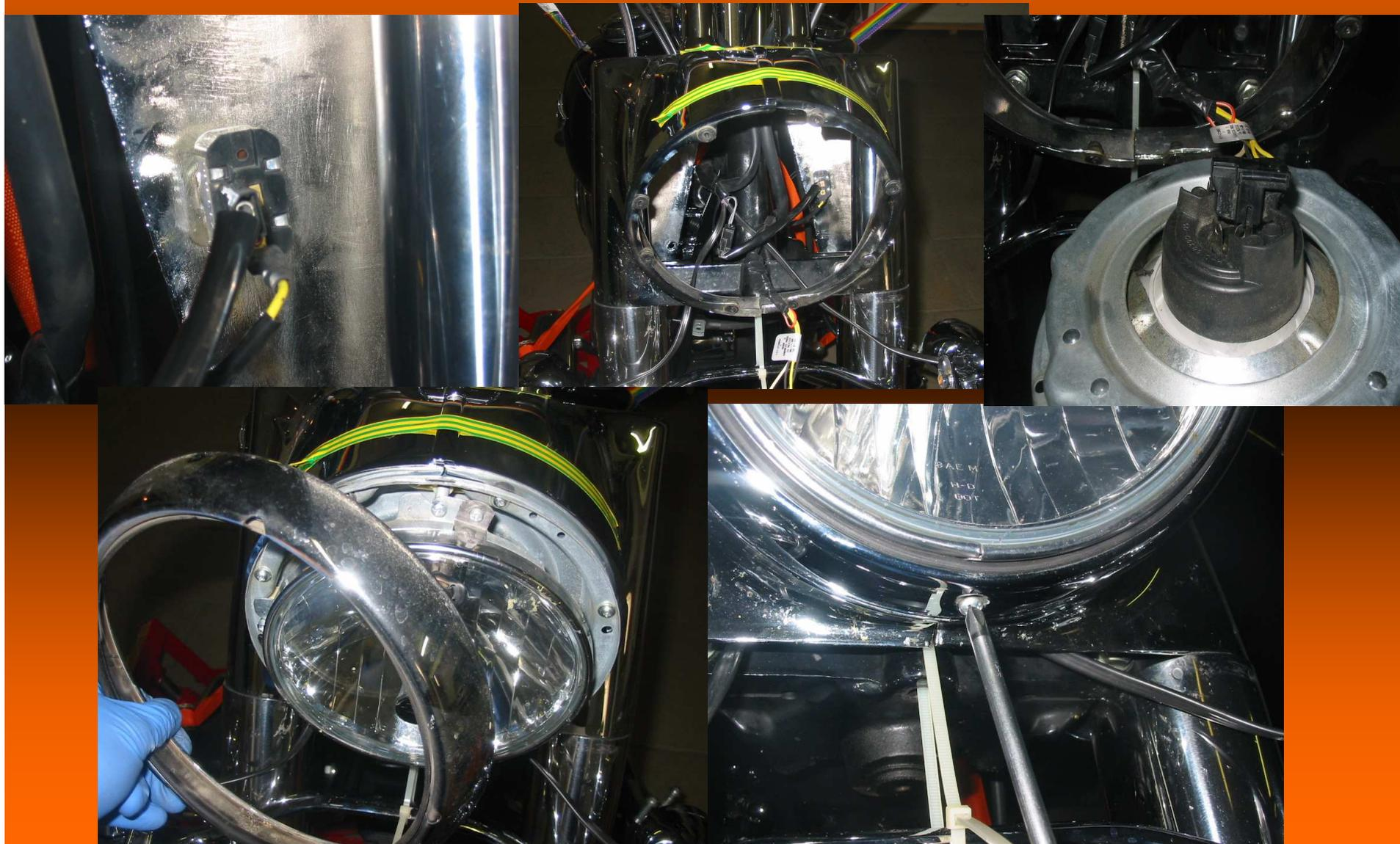
SEGUE IL RIMONTAGGIO DEL SUPPORTO FANALI SUPPLEMENTARI. UTILIZZIAMO DEL FISSANTE PER LE VITI. E' UTILE PULIRE LE VITI CON RESIDUI DI COLLA E RUGGINE CON UNA SPAZZOLA D'ACCIAIO.
