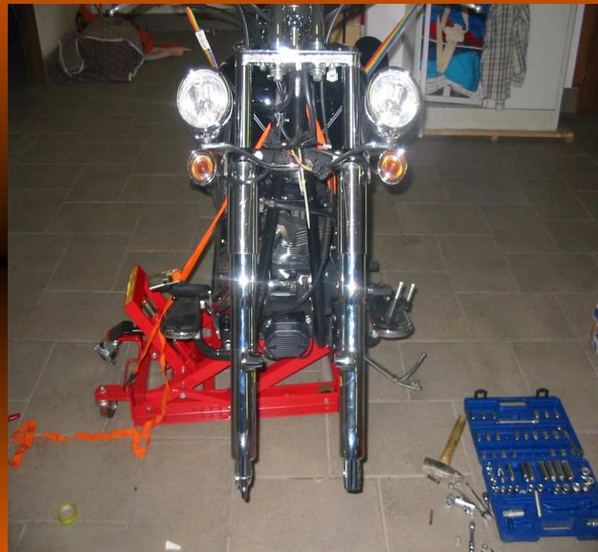
PROCEDERE QUINDI AL RIMONTAGGIO DEL FARO FACENDO IL PERCORSO CONTRARIO ALLO SMONTAGGIO, QUINDI: RICOLLEGARE L'INTERRUTTORE DEI FARI SUPPLEMENTARI, POSIZIONARE IL NACELLE, RICOLLEGARE IL FANALE QUINDI FISSARLO CON LE SUE VITI, INFINE RIMONTIAMO LA GHIERA.
